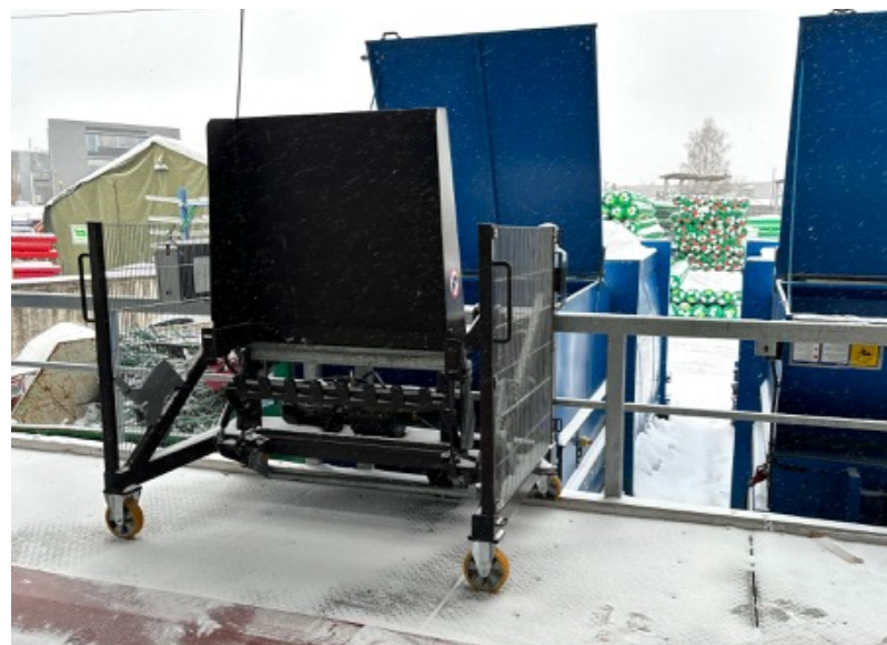
MOBIL VIPPELØSNING: Den nye vippeløsningen kan ruller bortover rampa til riktig avfallspresse.
